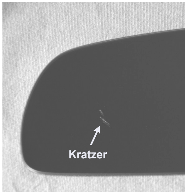
Prüfobjekt mit Kratzern
